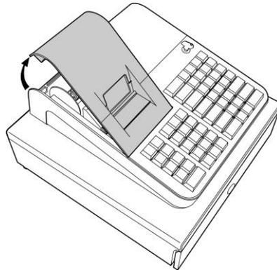
Legen Sie die Papierrolle in das Druckwerk (Abrollrichtung von unten nach vorne) und ziehen Sie das Papier bis in den Bereich der Tastatur.
