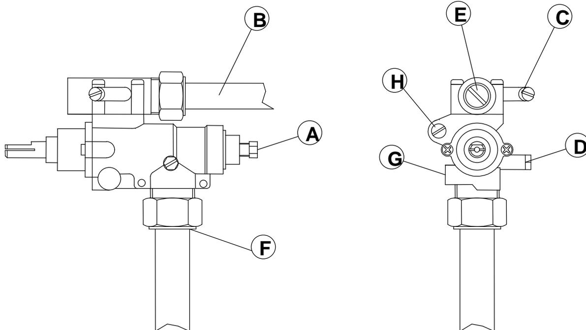
**4.4. BRUCIATORE PILOTA - BRÛLEUR PILOTE - PILOT BURNER -
