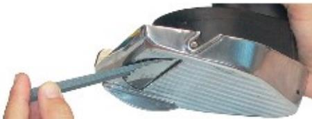
Abb. 43 Schleifstein an der Unterseite des Kreismessers anlegen
