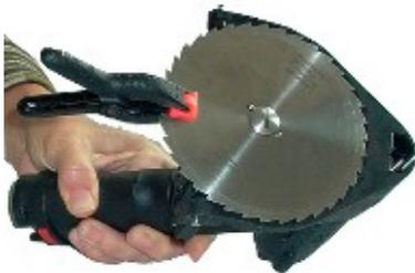
Abb. 28 Kreismesser mit Grip-Zange fixiert
