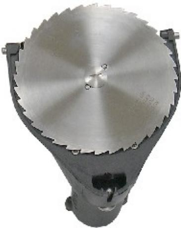
Abb. 30 Kreismesser eingebaut
