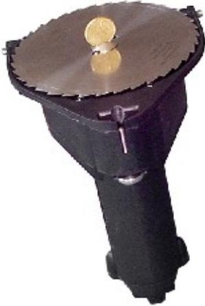
Abb. 26 Messerschraube mit eingesteckter Münze
