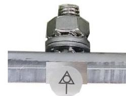
Die Schraube für den Potentialausgleich befindet sich hinter der Abdeckung an der Frontseite der Maschine.
