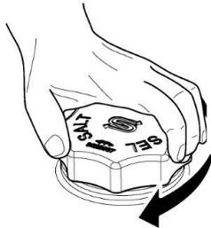
2. Die Dichtung und das Gewinde des Salzlösebehälters reinigen und gut verschließen. Das Eindringen von Spülwasser kann zu Kapazitätsverlusten beim Enthärter führen!
