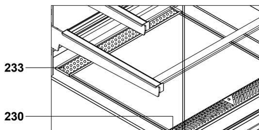
230 - Ansaugvorrichtung - trägt zum korrekten Durchfluss der gekühlten Luft innerhalb des Regals bei. Das Bedecken der Perforationen ist verboten!
