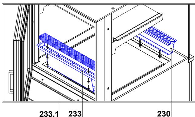
230 - Ansaugung - trägt zur ordnungsgemäßen Zirkulation von gekühlter Luft bei. Das Abdecken der Perforationen ist verboten!
