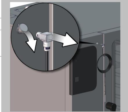
Stecken Sie den externen Kerntemperaturfühler oder Sous-Vide-Fühler vom Gerätegehäuse ab.
