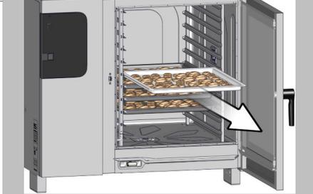
Schließen Sie die Verriegelung der Beschickungsebenen wieder. Heben Sie dafür den Arretierbügel an, schwenken Sie ihn anschließend um 180° nach rechts und lassen Sie den Arretierbügel wieder absinken.
